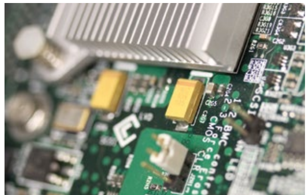
Auf bestückten Leiterplatten finden sich Tantal enthaltende Polymerchip-Kondensatoren. Diese will „gagendta+“ zurückgewinnen.
